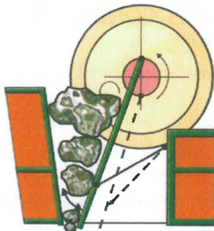
Figura 1 – Britador de mandíbulas de 1 eixo. (fonte: MANUAL METSO, 2005)
