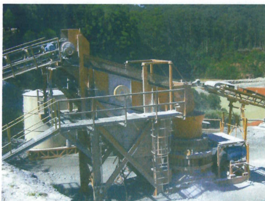
Figura 8 – Britador cônico quaternário operando em conjunto com peneira de escalpe P3.
